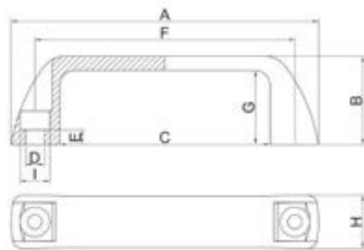
**MATERIALE. MATERIAL. MATERIAL.****Termoplastico ad elevata resistenza meccanica.****A richiesta materiali con tenuta termica o ad alto impatto.**
