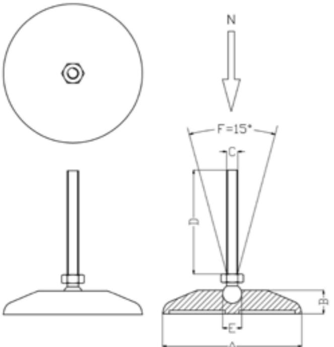
**MATERIALE. MATERIAL. MATERIAL.****Termoplastico ad elevata resistenza meccanica.****A richiesta materiali con tenuta termica o ad alto impatto.**
